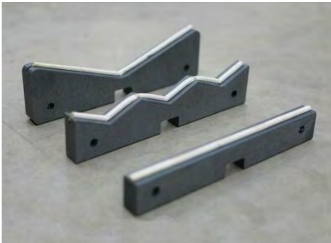
Billedet viser de 3 standard holdere, der p.t. findes til løfteværktøjet-
